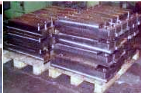
MAILLONS DE CHAINE DE MANNEQUIN DE COULEE CONTINUE ET REPARATION
