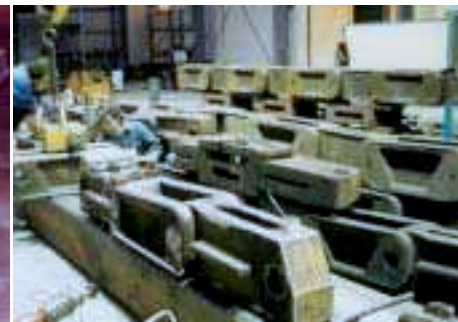
MAILLONS DE CHAINE DE MANNEQUIN DE COULEE CONTINUE ET REPARATION
