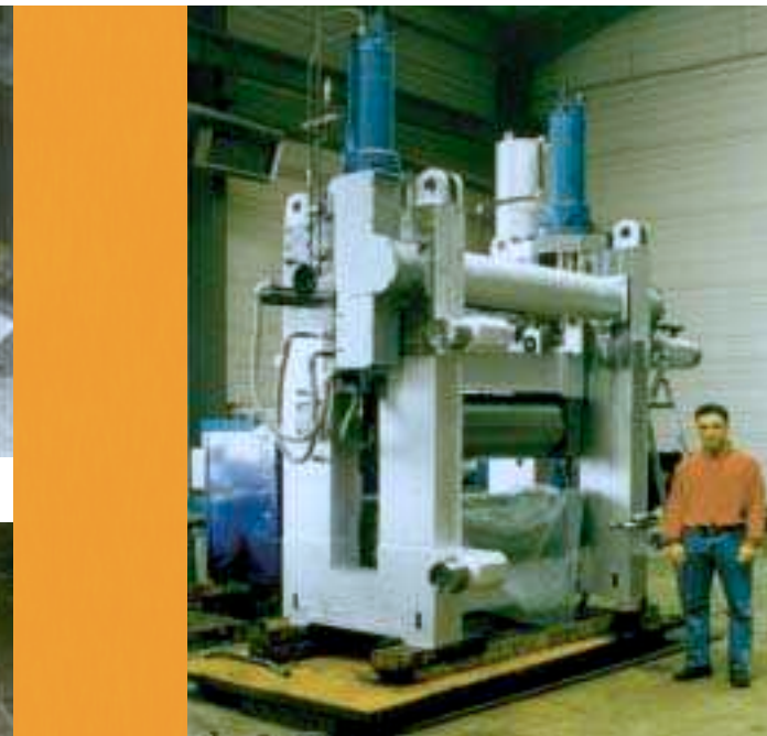
CAGE EXTRACTRICE DE BEAMS (16 Tonnes)
