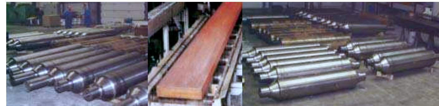
BRAME EN COULEE ET SERIE DE ROULEAUX DE COULEE CONTINUE
