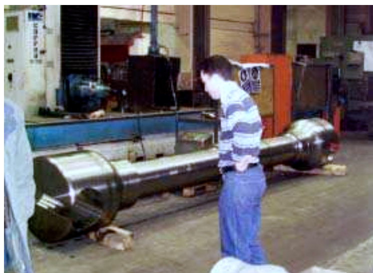
EBAUCHE D'ALLONGE DE 5M & 12 TONNES
