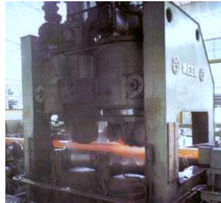
Galet hyperbolique avec son axe et ses paliers Matière: acier à outil à 13% Chrome +Mo+V.
