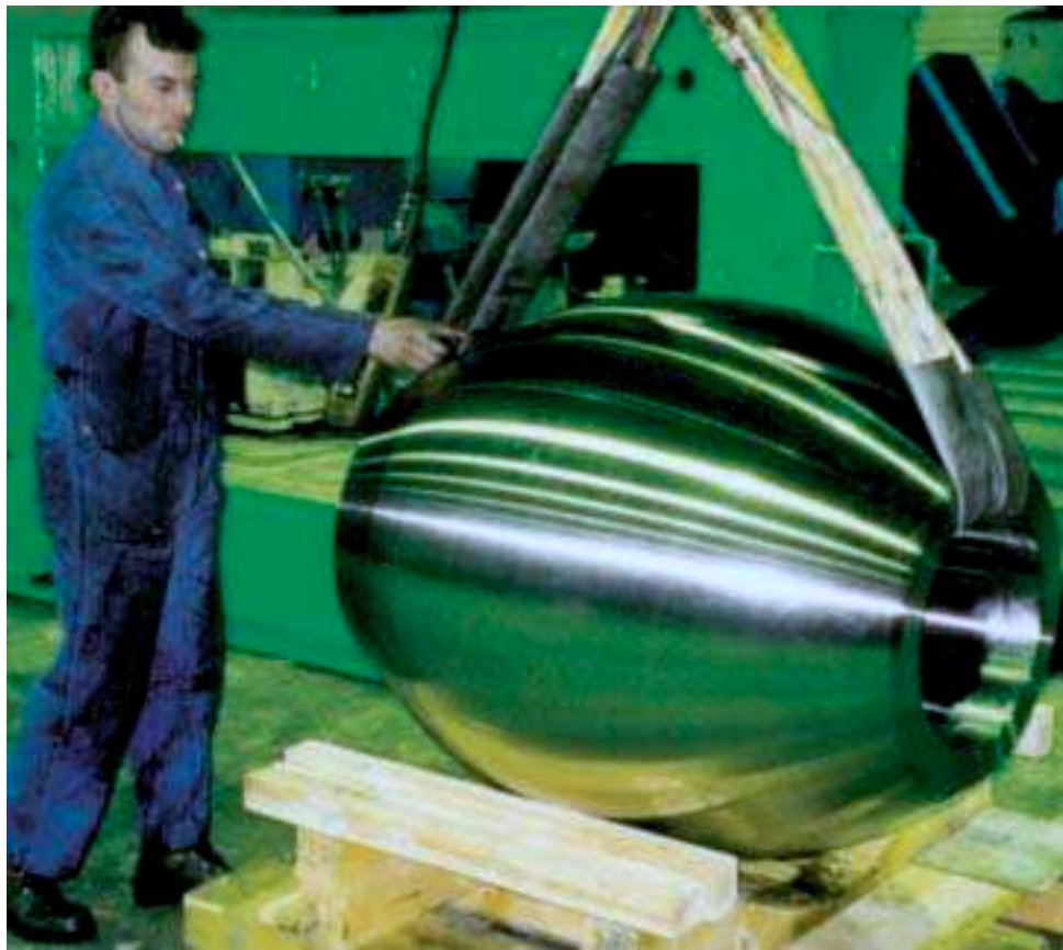
Galet diamètre 910mm Poids: 2.850Kg
