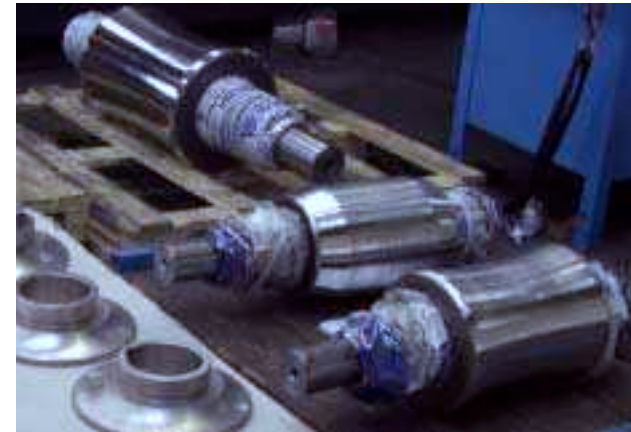
Retouche et remise à profils de galets dresseurs hyperboliques sur axe
