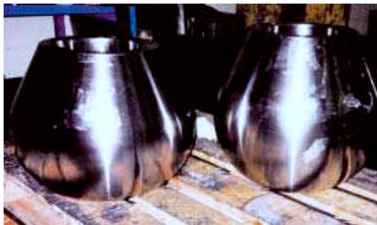
Galet diamètre 450mm Poids: 320Kg
