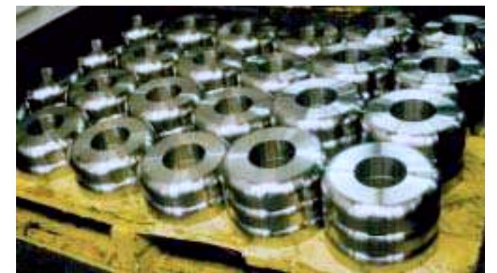
Galets pour pliage de tôle réalisés en Z155CDV12 traités 58/60 HRC
