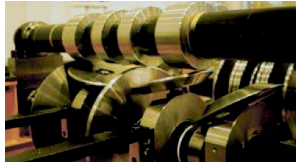
Galets pour profilage de tôle fine montés sur arbre et outillage de rechange réalisé en 42CD4 traité 80/100 kg/mm 2
