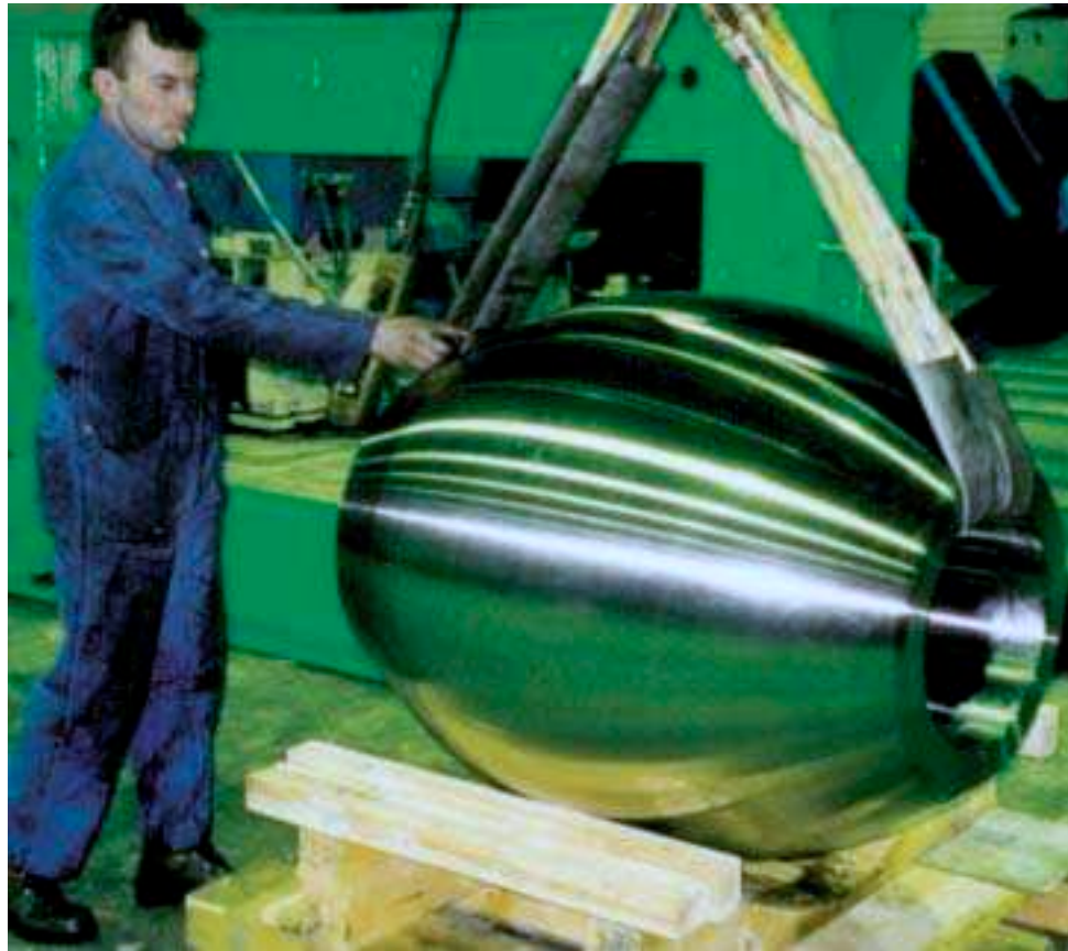
Galet diamètre 910mm Poids: 2.850Kg
