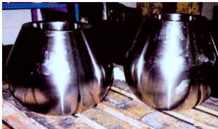
Galet diamètre 450mm Poids: 320Kg
