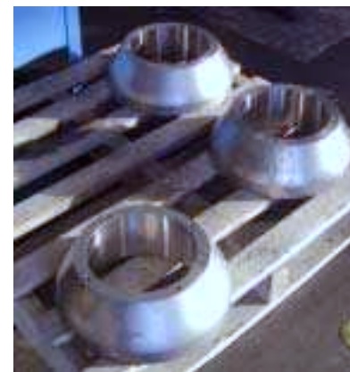
DIFFERENTS TYPES DE GALETS POUR LAMINOIR : Galets de guidage, torsion et dressage
