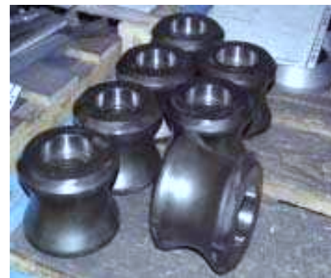
DIFFERENTS TYPES DE GALETS POUR LAMINOIR : Galets de guidage, torsion et dressage
