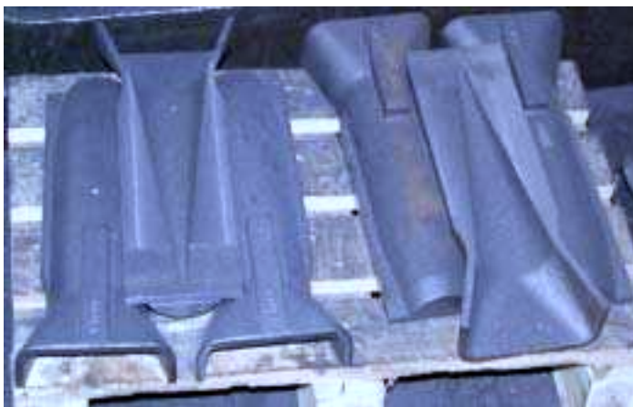
DEMI-GUIDES BRUTES AVANT USINAGE
