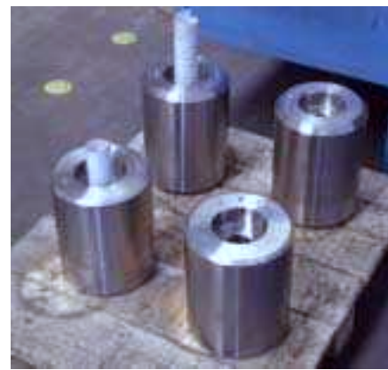
DIFFERENTS TYPES DE GALETS POUR LAMINOIR : Galets de guidage, torsion et dressage
