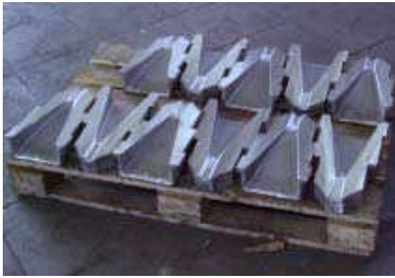
Unterschiedliche Typen von Halbführungen für Walzstrassen
