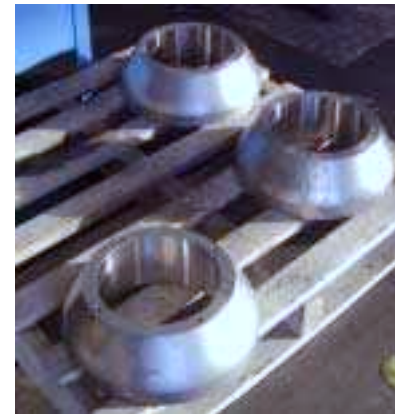
Verschiedene Type von Rollen für Walzstrasse : Führungs-, Torsions- und Richtrollen
