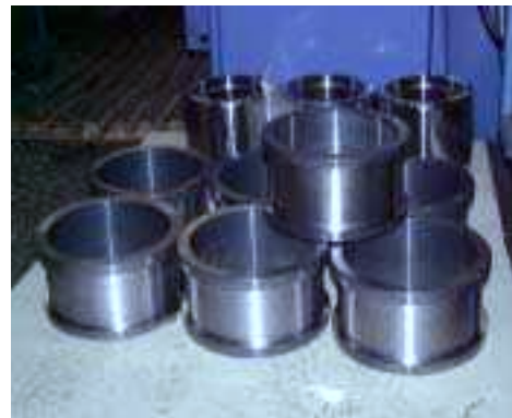
Verschiedene Kaliberrollen für Drähte und Stäbe
