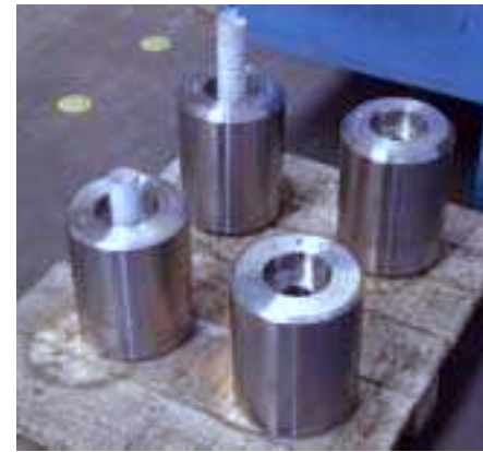
Verschiedene Type von Rollen für Walzstrasse : Führungs-, Torsions- und Richtrollen
