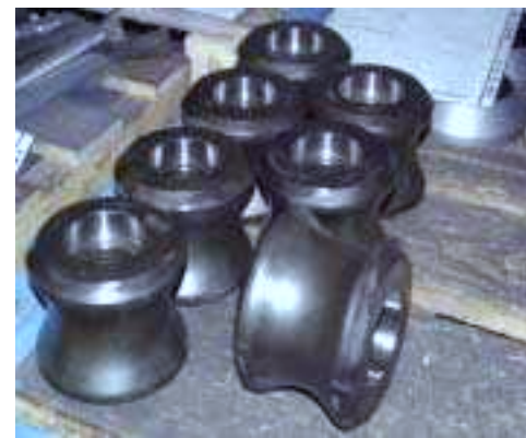
Verschiedene Type von Rollen für Walzstrasse : Führungs-, Torsions- und Richtrollen
